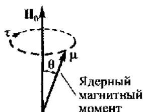
Рис. 21. Прецессия магнитного момента \mu вокруг направления внешнего магнитного поля напряжённостью H_0
